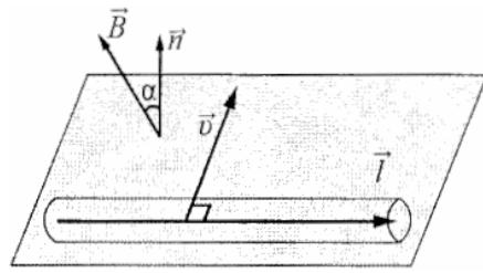
$ E_i  = Blv \cos \alpha, \text{ где } \alpha - \text{угол между вектором } B \text{ и нормалью } \vec{n} \text{ к плоскости, в которой лежат векторы } \vec{l} \text{ и } \vec{v}; \text{ если } \vec{l} \perp \vec{B} \text{ и } \vec{v} \perp \vec{B}, \text{ то }  E_i  = Blv$                                                                     |
