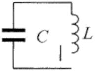
$\begin{cases} q(t) = q_{\max} \sin(\omega t + \phi_0) \\ I(t) = q'_t = \omega q_{\max} \cos(\omega t + \phi_0) = I_{\max} \cos(\omega t + \phi_0) \end{cases}$<br>Формула Томсона: $T = 2\pi\sqrt{LC}$ , откуда $\omega = \frac{2\pi}{T} = \frac{1}{\sqrt{LC}}$ .<br>Связь амплитуды заряда конденсатора с амплитудой силы тока при свободных электромагнитных колебаниях в идеальном колебательном |
